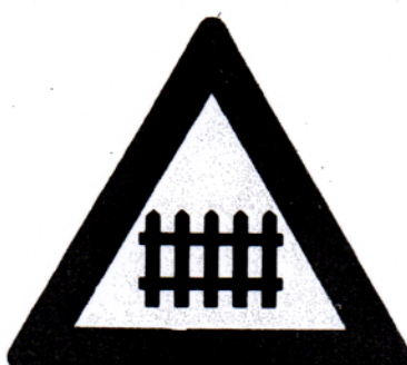
Κ - 31 Κίνδυνος εξαιτίας ισό- πεδης σιδηροδρομικής διάβασης με δρύφρακτα ή ήμιδρύφρακτα.
