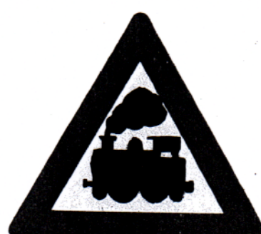
Κ - 32 Κίνδυνος εξαιτίας ισό- πεδης σιδηροδρομικής διάβασης χωρίς δρύ- φρακτα ή ήμιδρύφρα- κτα.
